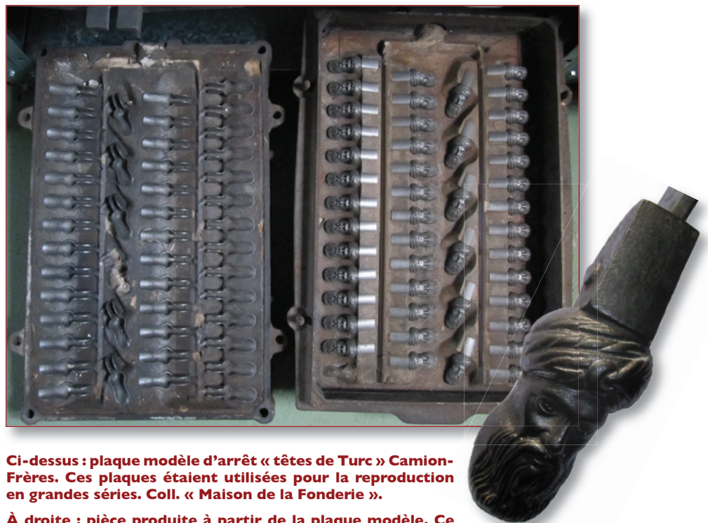
À droite : pièce produite à partir de la plaque modèle. Ce Turc sera fabriqué en grande série jusqu'à 1980.
